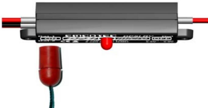
Pour le cas ou pour le **DPSI Micro - DualBat**, un accu n'est pas connecté, ou défectueux, le DPSI comme en mode de programmation. Ce mode de programmation sera automatiquement quitté après 30 secondes. Pendant ces 30 secondes, l'accu manquant ne doit pas être connecté, si aucune nouvelle programmation n'est pas souhaité.
