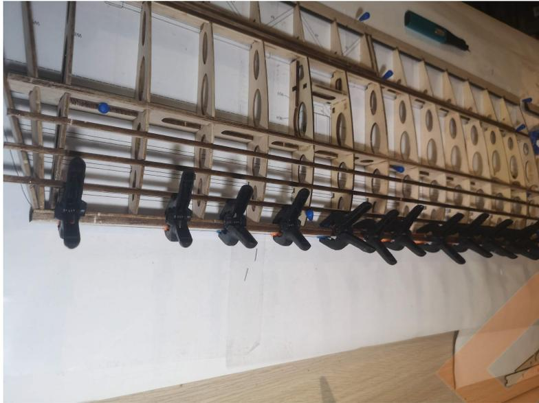
15/Coller la nervure de finition W1 et la tige de centrage en carbone.
