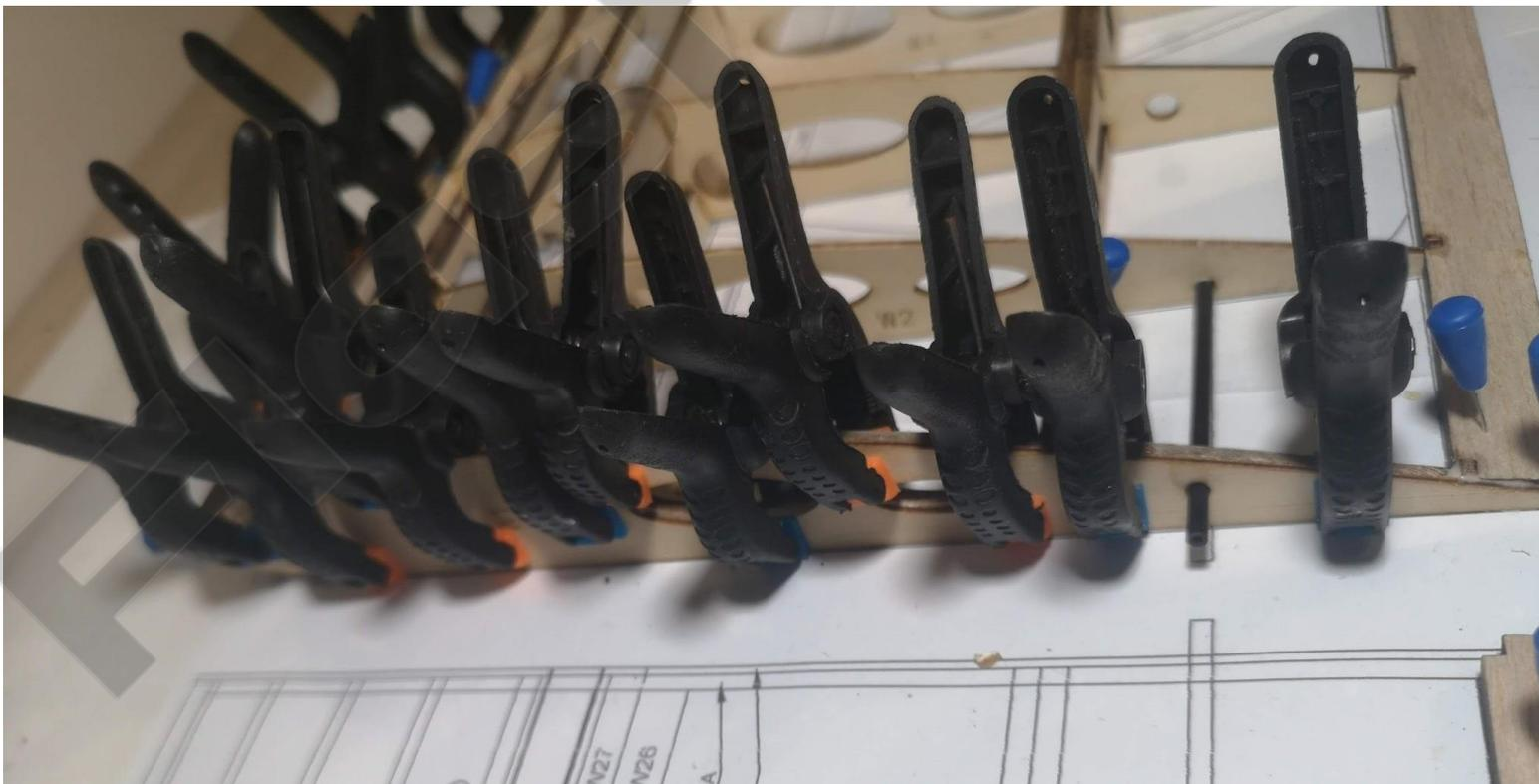
16/Ajuster et coller le coffrage W2, attention à l'alignement des trous du support de hauban.
