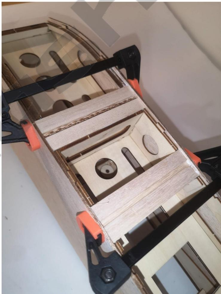
14/ Coller les renforts triangulaires FK1A sur le couple moteur et les renforts FK3 /FK4 sur les fixations d'ailes.
