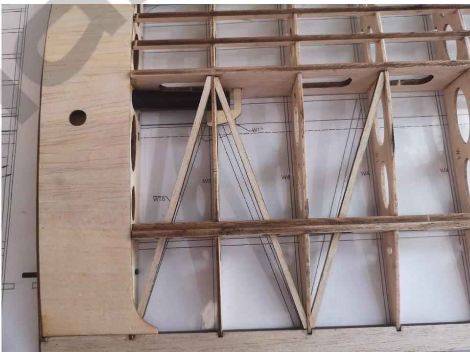
19/Retourner l'aile et y coller à l'époxy le fourreau de clé d'aile de 11cm et la butée W17.
