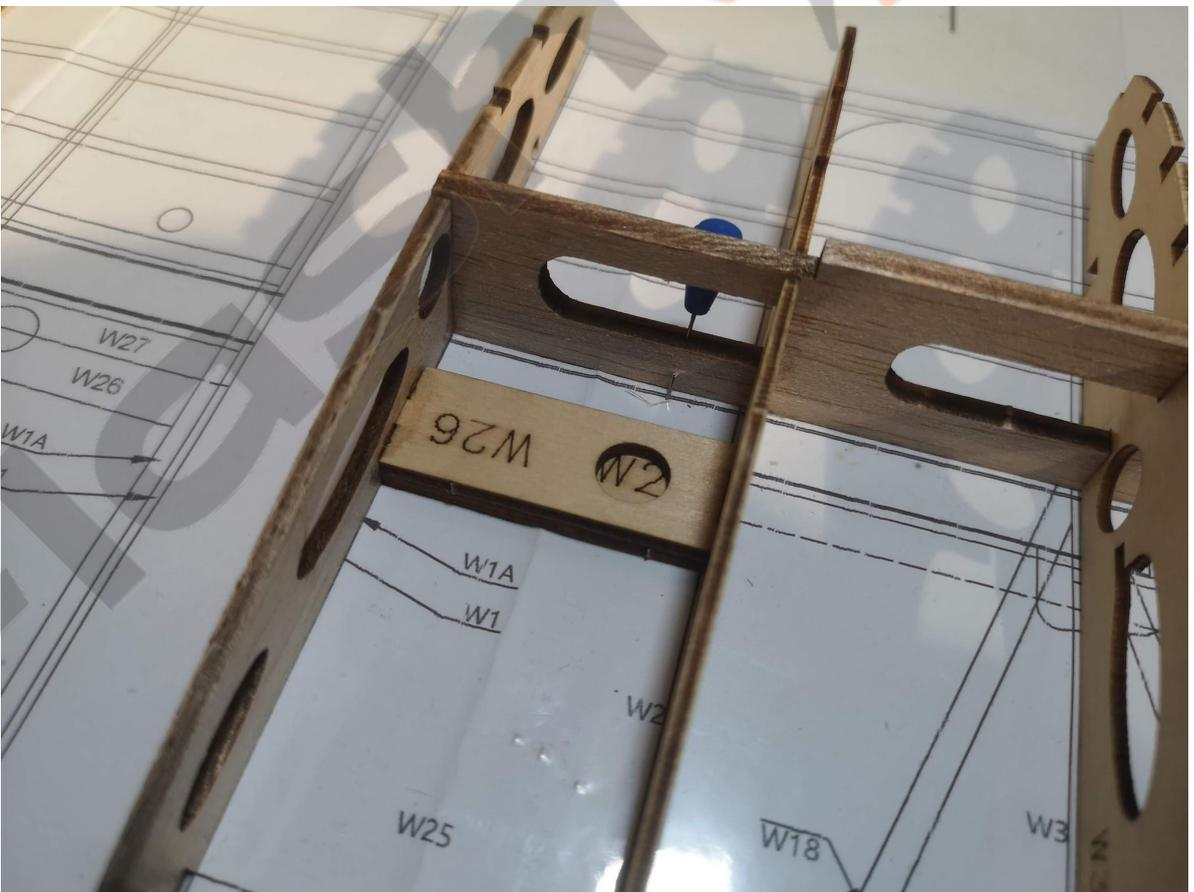
7/Coller les 3 baguettes #20 sur l'avant des nervures .
