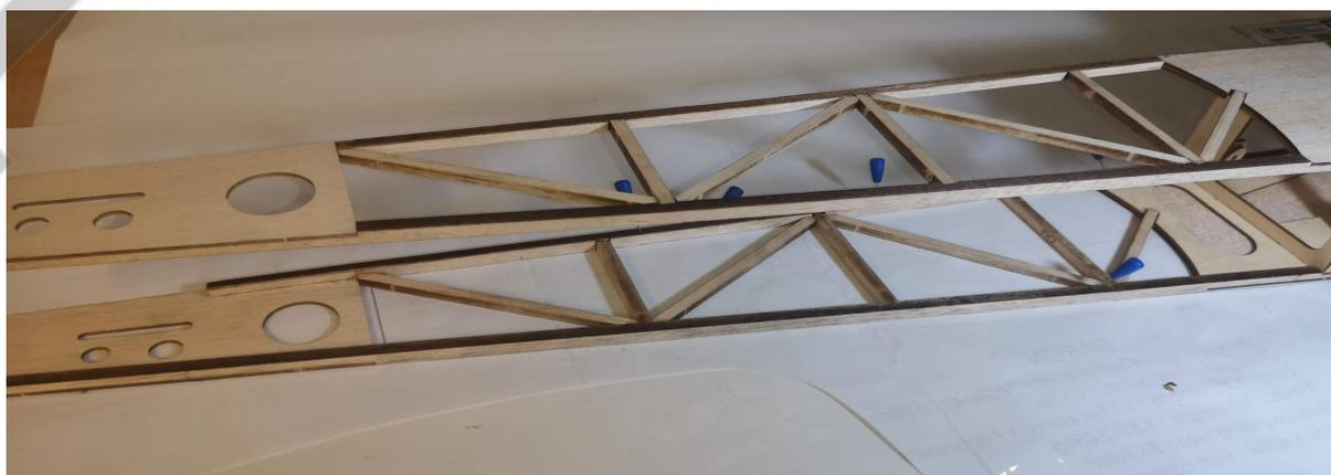
19/Sur le plan, vu de dessus, poser le fuselage à l'envers et y coller l'assemblage F7A, ainsi que les pièces F6, F5 en respectant le bon alignement du fuselage sur le plan.
